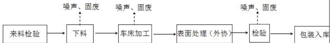
图3 防松套生产工艺流程及产污环节图
